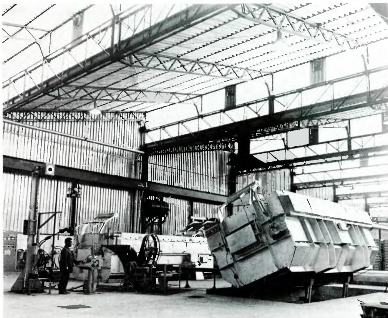
Οι δύο ηλεκτρικοί φούρνοι και στη μέση τὸ σύστημα ὀριζοντίου χυτεύσεως μετὰ τροχοῦ.
