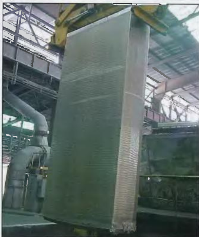
Η πλάκα μεγάλου πλάτους και βάρους 15 τόνων μετά τη χύτευση.
