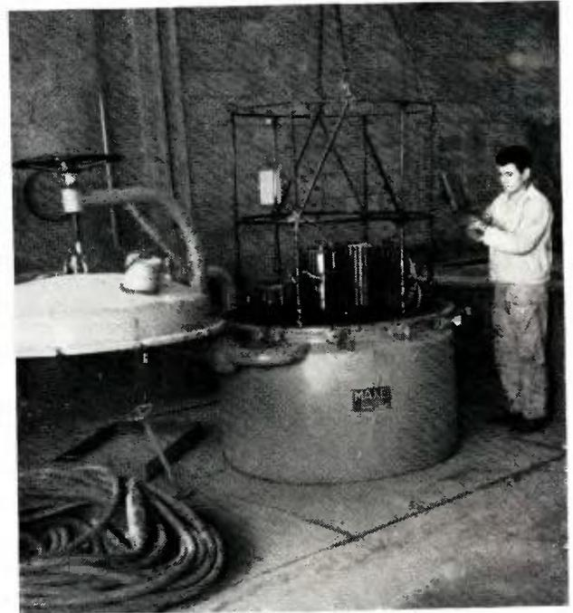
'Ηλεκτρολογικόν Συνεργείον. Έξαγωγή κινητήρων από τόν αυτόκλειστο κλίβανο βαφής, πραγματοποιουμένη από τόν κ. Ψαρά.
