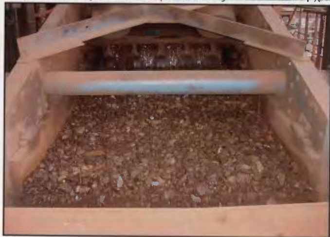
Το τελευταίο πλύσιμο του απασβεστοποιημένου βωξίτη πριν την απομάκρυνση από το τμήμα.
