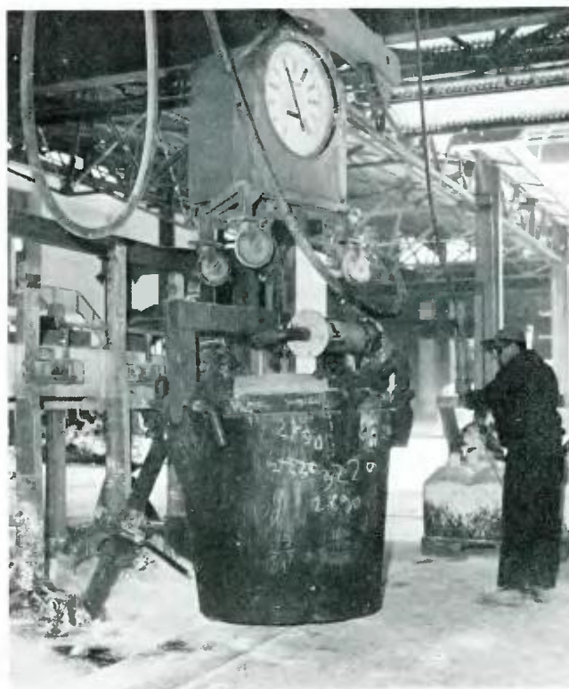
Ἀναρρόφηση μετάλλου ἀπὸ τὴν λεκάνη ἠλεκτρολύσεως.
