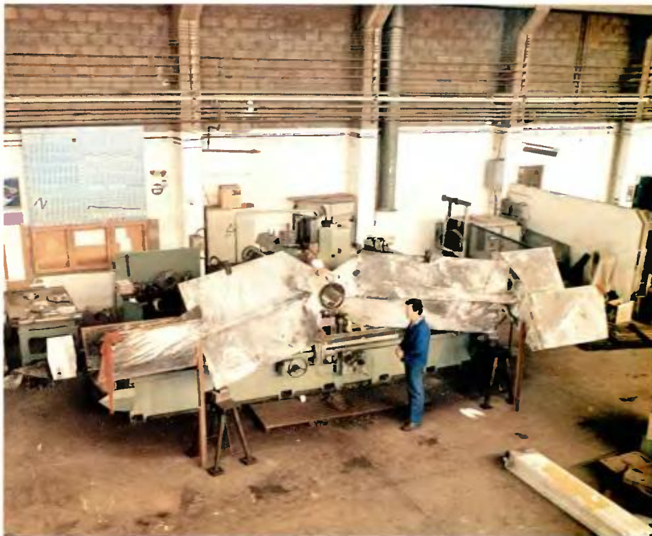
Πανοραμική άποψη των πτερυγίων της ανάδευσης κατά τη διάρκεια του φρεζαρίσματος. Παρακολουθεί ο χειριστής της φρέζας κ. Ζουλφός.
