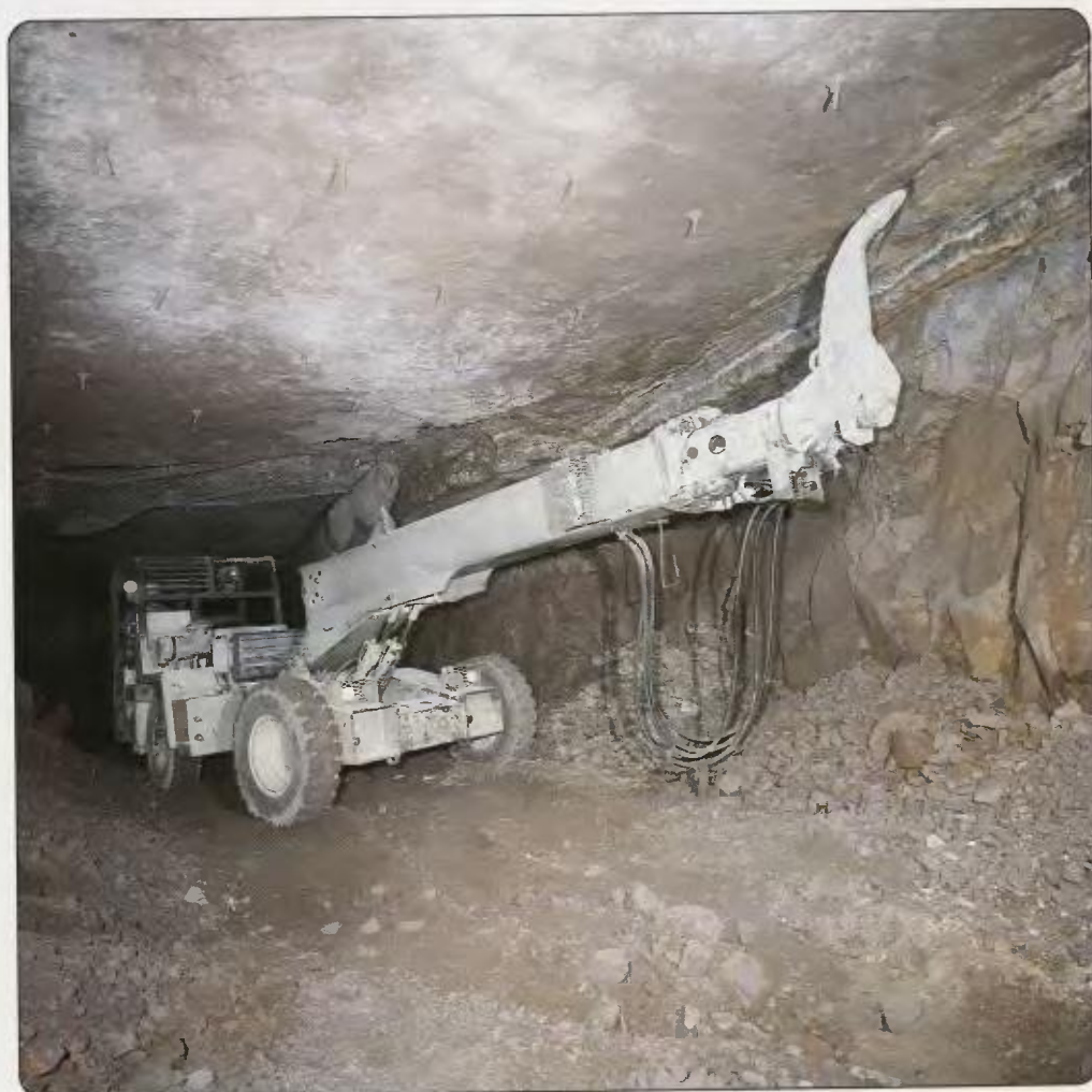
Μηχάνημα αποκόλλησης επισφαλών όγκων σε υπόγεια εξόρυξη βωξίτη.
