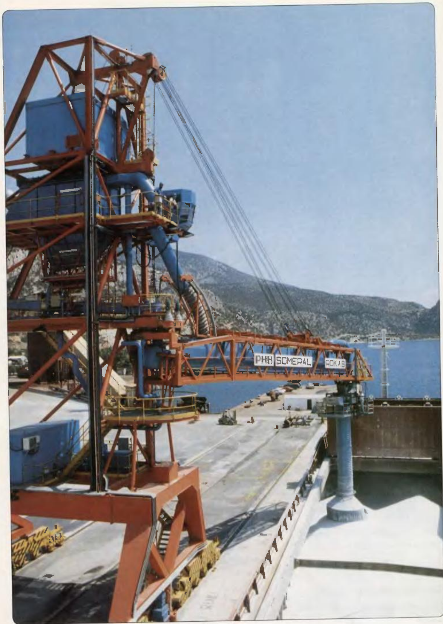
Το σύστημα φόρτωσης αλουμίνας σε πλοία, σε λειτουργία μέγιστης παροχής.
