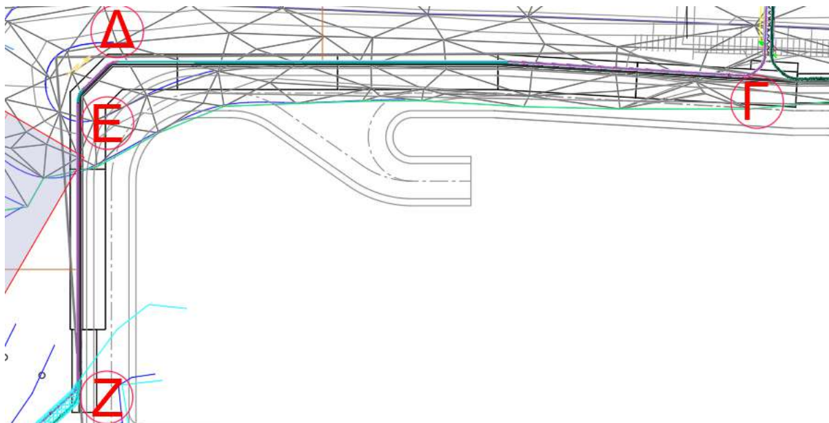
Σχήμα 6.39: Όδευση καλωδιακών συστημάτων επί του τοίχους αντιστήριξης του νέου Σταθμού 826MW.
