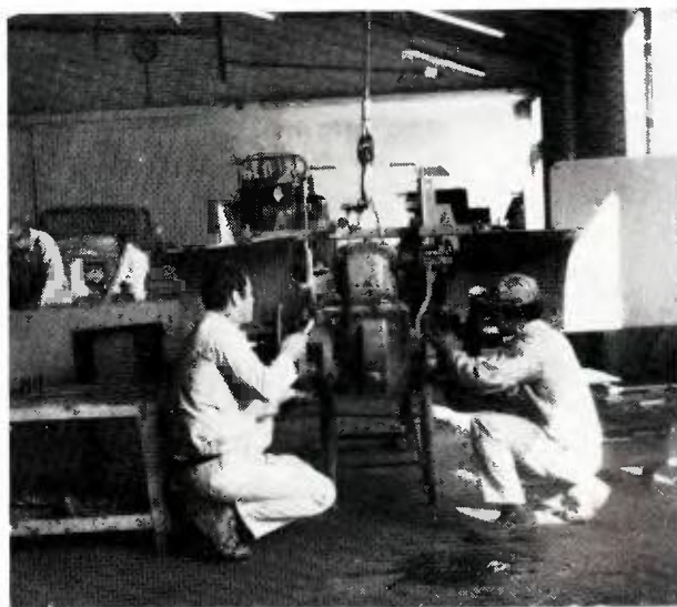
Οἱ κκ. Κοροδῆμος καὶ Κεφάλας τοποθετοῦν τὸν ἄξονα ἑνὸς ἀνυψωτικοῦ μηχανήματος, τὸ ὁποῖο ὑπέστη γενικὴ ἐπισκευή.
