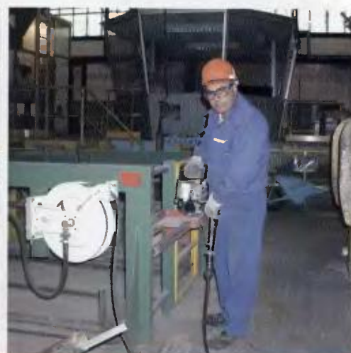
Μία από τις πολλές βελτιώσεις της ομάδας. Η νέα μηχανή δεσίματος πλακών (πολύ πιο ελαφριά - αναρτάται από βάση) κάνει πολύ πιο ασφαλή και ξεκουραστή τη δουλειά των συναδέλφων στο πριόνι πλακών.
