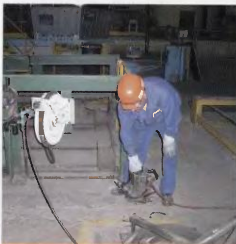
Μία από τις πολλές βελτιώσεις της ομάδας. Η νέα μηχανή δεσίματος πλακών (πολύ πιο ελαφριά - αναρτάται από βάση) κάνει πολύ πιο ασφαλή και ξεκουραστή τη δουλειά των συναδέλφων στο πριόνι πλακών.
