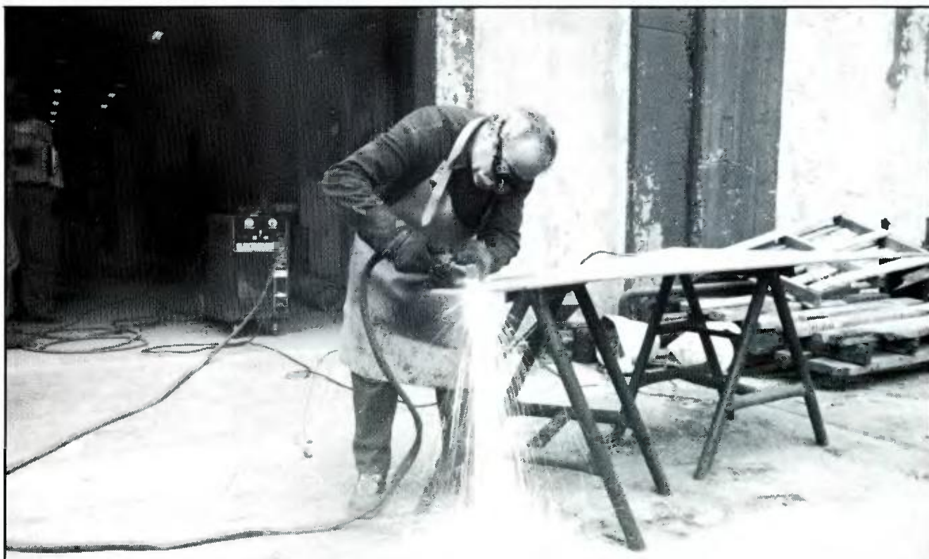
Ο κ. Χονδρομικαλής, ενώ κόβει ανοξείδωτο έλασμα, πάχους 8 χιλιοστών με τη συσκευή πλάσματος
