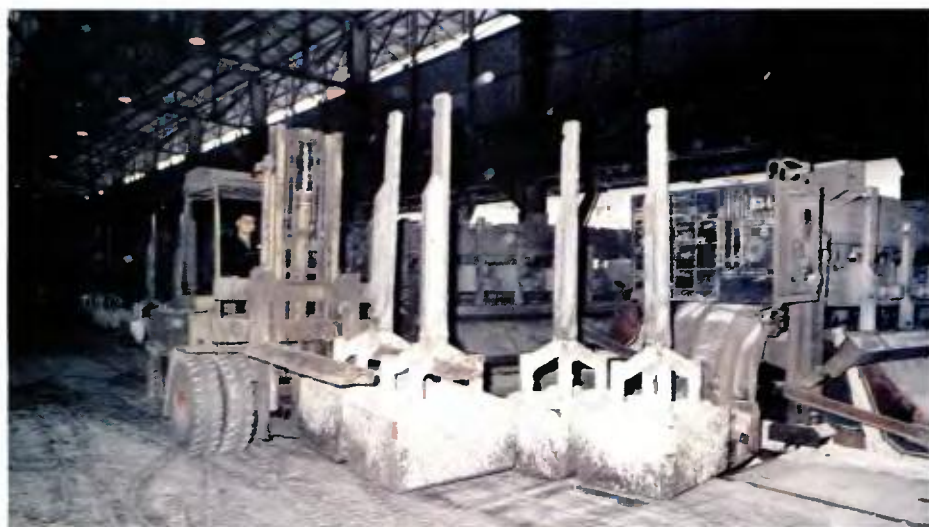
Τοποθέτηση νέων ανόδων στις εσωτερικές κεφαλές των λεκανών με το περνοφόρο όχημα (παλιός τρόπος).
