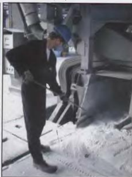
...με το εργαλείο στρωσίματος αλουμίνας.
