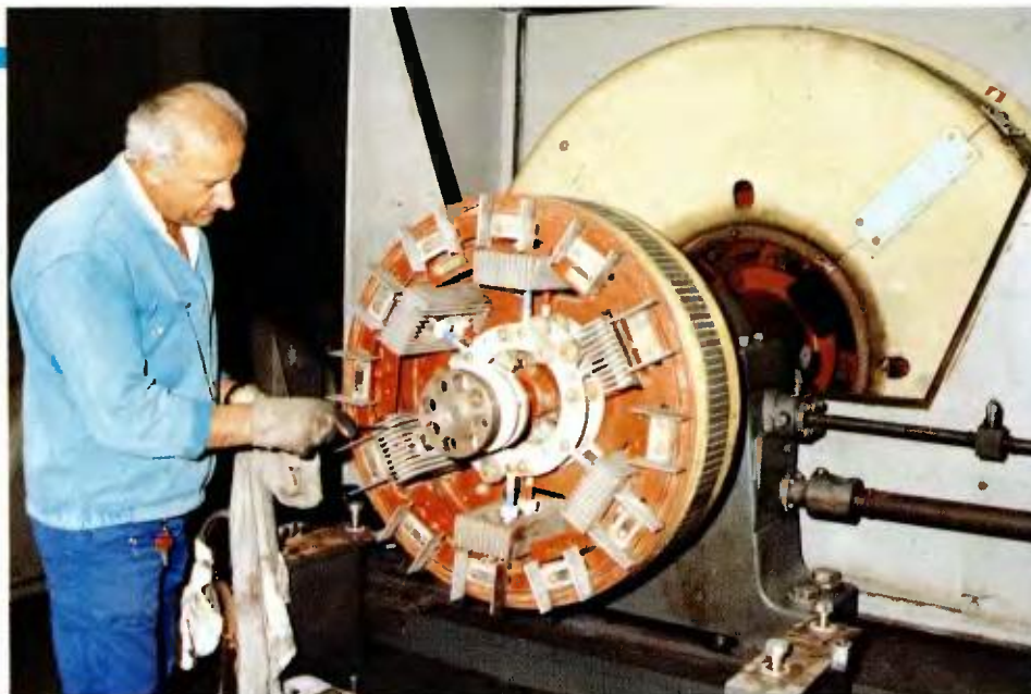
Η κύρια διεγέρτρια της γεννήτρια Νο2, η οποία δέχεται τις φροντίδες του κ.Χ.Θεοχάρη του ΗΛ/ΥΣ.
