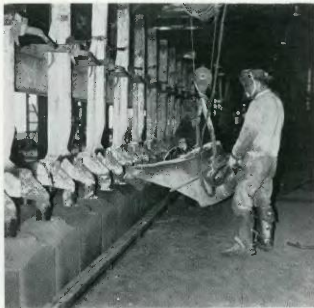
Οί κ.κ. Άρβανίτης και Τσουρής χύνουν ρευστό χυτοσίδηρο γύρω από τό τμήμα των ποδιών που είναι μέσα στην άνοδο.
