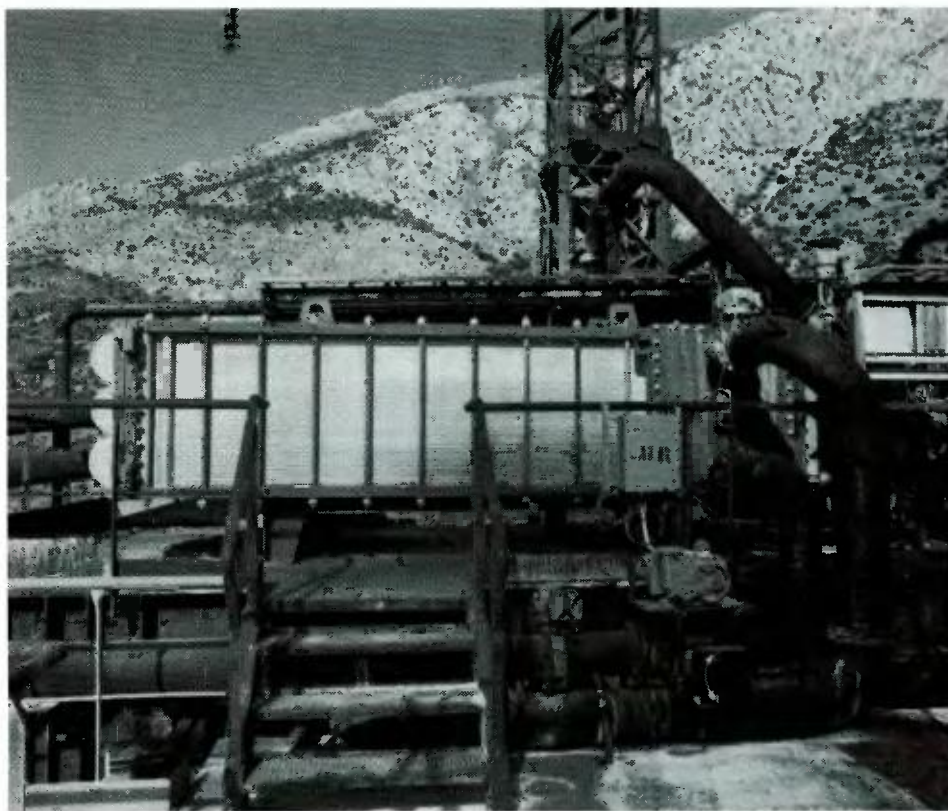
Αποψη των εναλλακτών Bariquand που ήδη λειτουργούν στο Τμήμα Διάσπασης.
